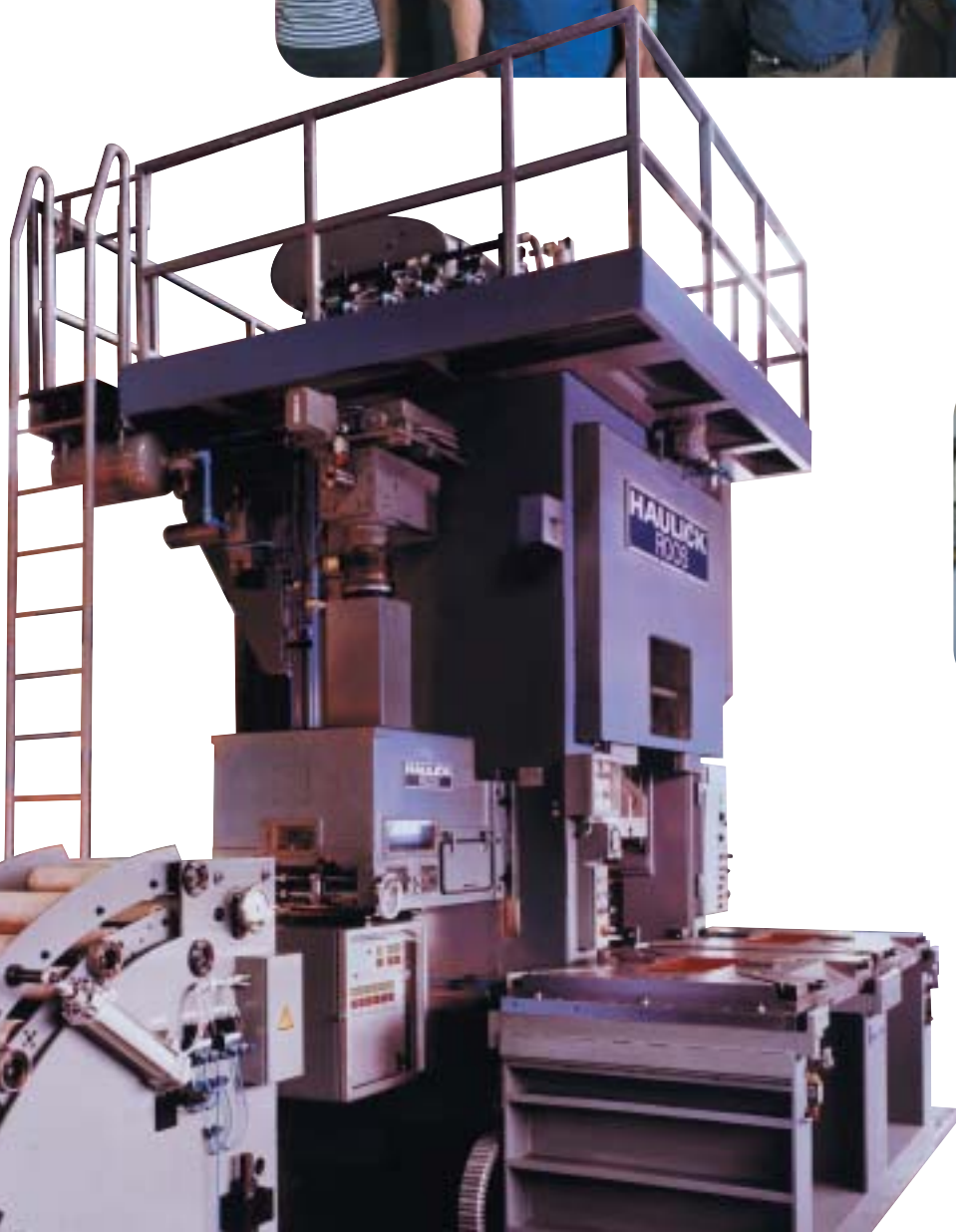
Vollautomatische Stanz- und Umformanlage
