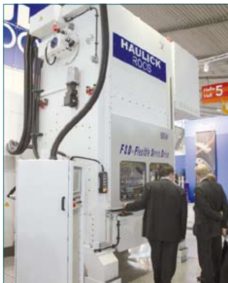
Präzisionsstanzautomat mit zuschaltbarem Servoantrieb. Hohe Hubzahl oder individueller Bewegungsablauf; beides ist möglich. (Bilder: Haulick + Roos GmbH)
